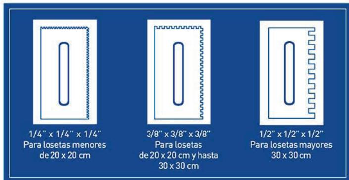
Con el uso de la llana dentada se logra regularizar el espesor de la capa de adhesivo y se evita dejar partes huecas entre el revestimiento y la pasta adhesiva, al permitir la expulsión del aire que de otra manera quedaría atrapado, formando burbujas que reducirían la superficie de contacto entre el revestimiento y el adhesivo.
